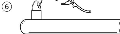
Далее одеваем коннектор на провода обогревателя и зажимаем его в месте контакта с проводами, используя инструмент.
